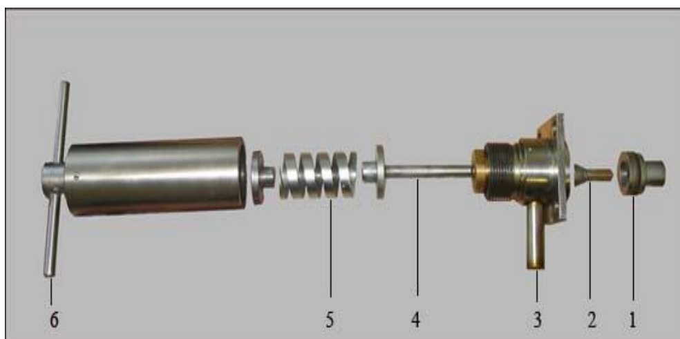
Рис.30 Гомогенизирующая головка в разобранном виде: 1 – седло клапана, 2 – клапан, 3 – выходной патрубков, 4 – шток, 5 – пружина, 6 – регулировочный винт.
