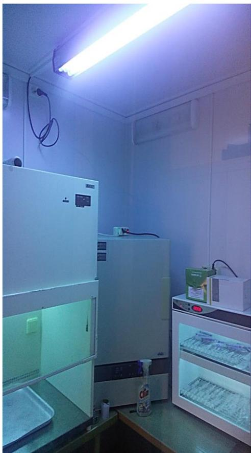
Рисунок 2. Полное УФ-облучение бокса. Включена потолочная УФ-лампа, бактерицидная камера (справа), рециркулятор воздуха (не видно на фото) и УФ-облучение внутри ламинара (слева). Полное облучение бокса необходимо проводить раз в неделю
