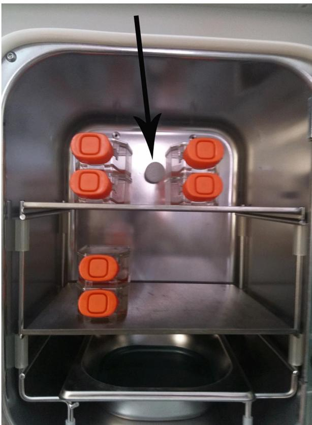
Рисунок 5. Внутренний вид инкубатора с подачей CO<sub>2</sub>. Внизу установлена емкость с раствором медного купороса. Стрелкой показан кожух датчика CO<sub>2</sub>
