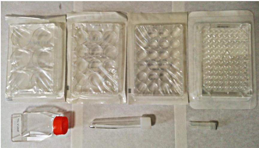
Рисунок 4. Лабораторный пластик для культивирования клеток. Верхний ряд, слева направо: планшеты на 6, 12, 24, 96 лунок. Нижний ряд, слева направо: культуральный флакон, пробирка со скошенным дном, криопробирка
