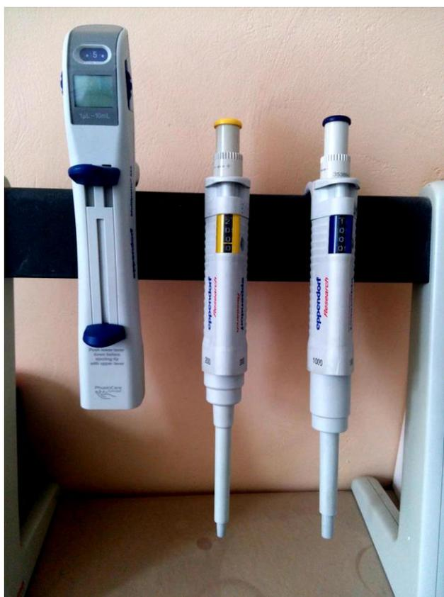
Рисунок 9. Степпер (слева) и автоматические одноканальные пипетки (в центре на 200 мкл, справа на 1000 мкл)
