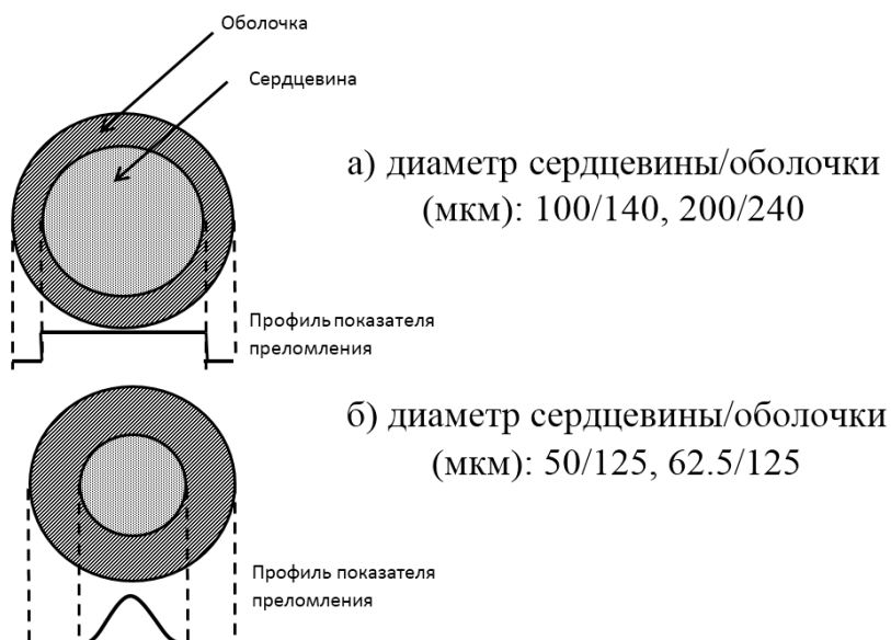
Рисунок 14 Типы многомодовых волокон: а) ступенчатое волокно, б) градиентное волокно
