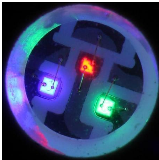
Рисунок 10 Расположение светодиодных чипов в трехцветном RGB-светодиоде
