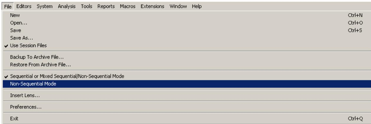
Рисунок 4.2 – Переход в режим непоследовательной трассировки луча (Non-Sequential Mode) в программе Zemax
