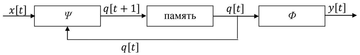
Рис. 2.13. Функциональная схема автомата Мура
