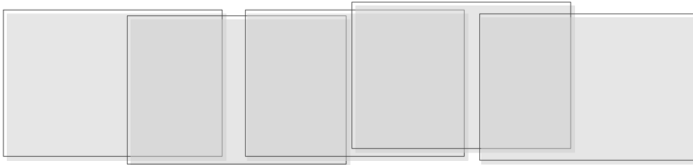
Рисунок 47 – Получение исходных изображений с перекрытием 40-50%
