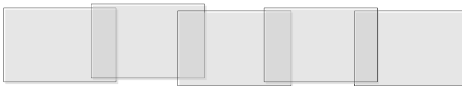
Рисунок 49 – Получение исходных изображений с перекрытием 15-20%
