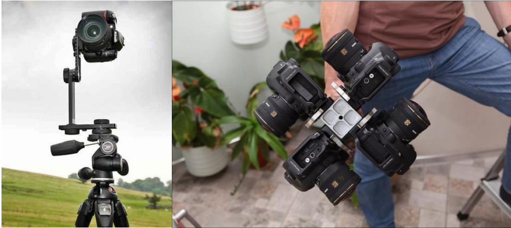
Рисунок 33 – Специальное поворотное устройство (слева) и комплекс из четырех камер (справа) для съемки сферических панорам
