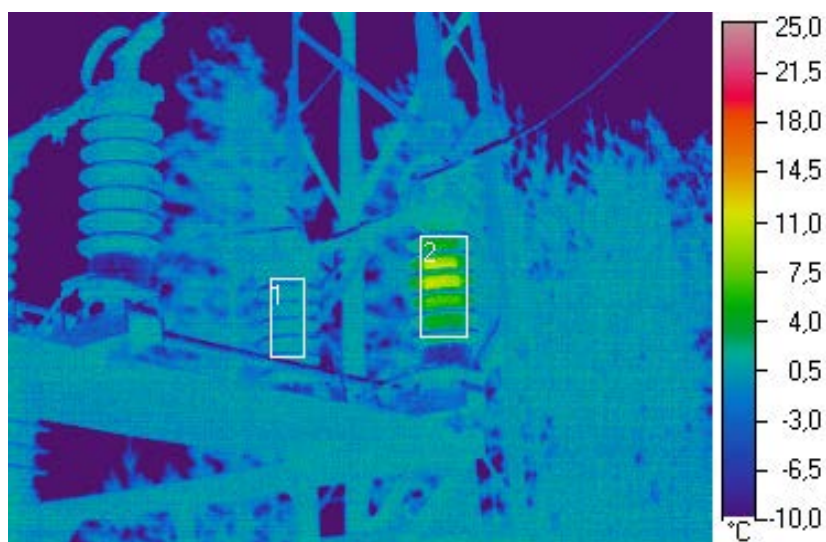
Рисунок 1.6 – Изображение дефектного изолятора выделено за счёт снижения детальности изображения сюжета. Тепловизионное изображение получено с помощью ТВП Р 640 фирмы FLIR и предоставлено сотрудниками ФГОУ ПЭИПК
