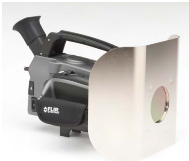
Рисунок 3.14 – Специальный экран для уменьшения погрешностей измерения температуры с помощью ТВП FLIR 640
