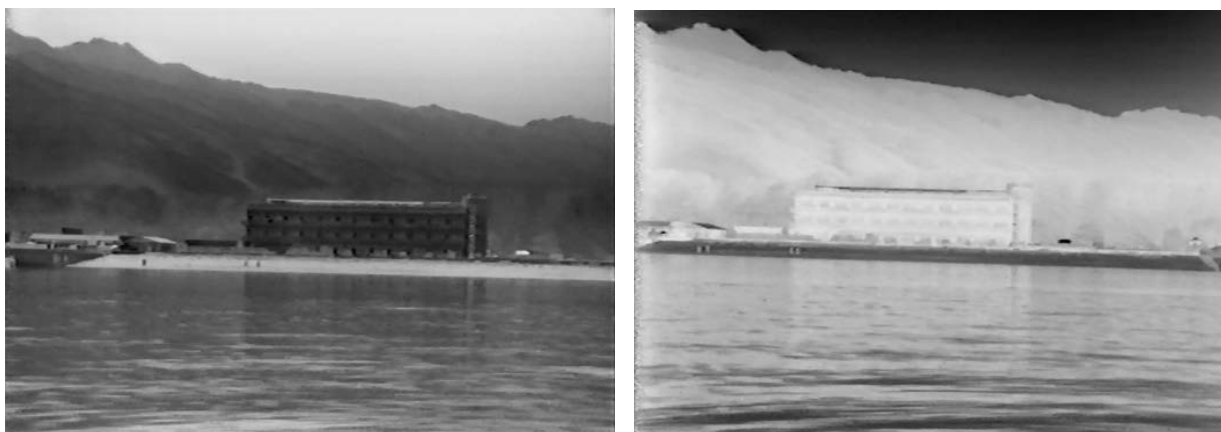
Рисунок 3.22 – Тепловизионное изображение диапазона 8 – 12 мкм здания в режимах «позитив» - «негатив»
