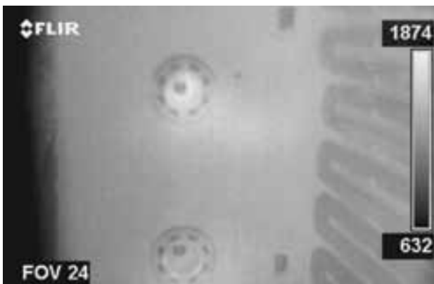
Рисунок 2.2 – Тепловизионное (а) и телевизионное (б) изображения высокотемпературной камеры сгорания с примером измерения температуры объекта. Заимствовано из рекламных материалов фирмы FLIR (Thermal imaging camera FLIR GF309)
