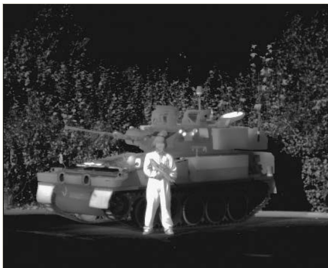
Рисунок 3.8 – ТВП с использованием QWIP МФПУ форматом 640×480 элементов. Заимствовано из рекламных материалов фирмы SOFRADIR
