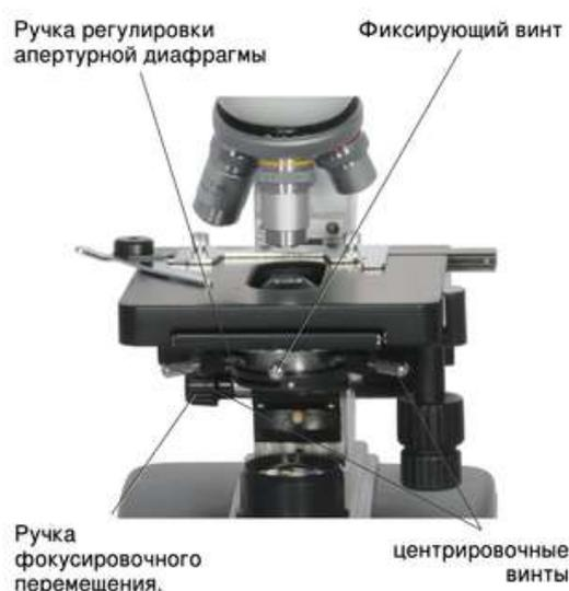
Рисунок 3 - Узел крепления конденсора с возможностью центровочного и фокусирующего перемещения
