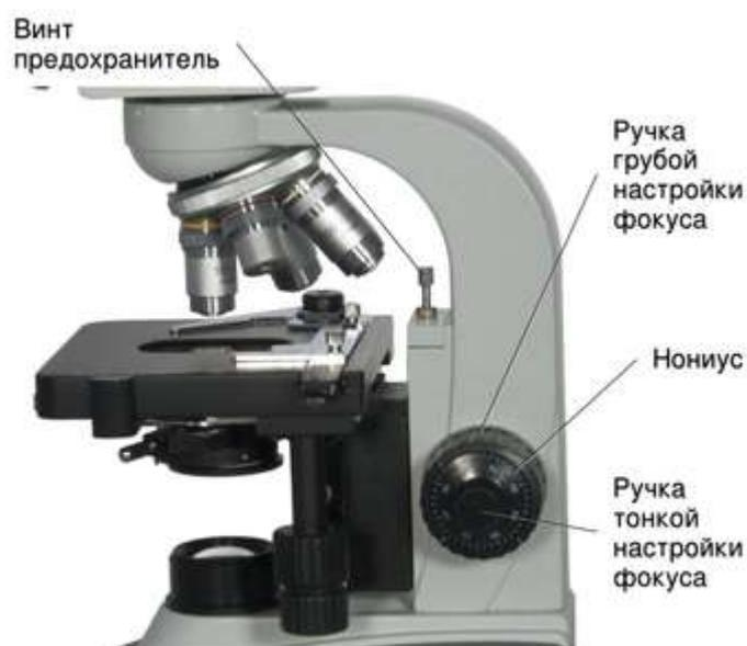
Рисунок 2-Фокусирующий механизм микроскопа
