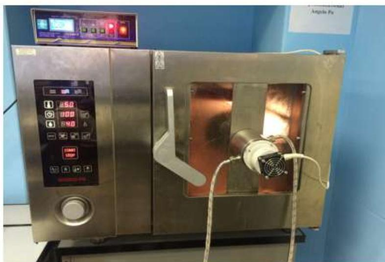
Общий вид экспериментальной установки, состоящей из пароконвектомата «Angelo Po Fx61e1» со встроенным ультразвуковым генератором «Соловей».
