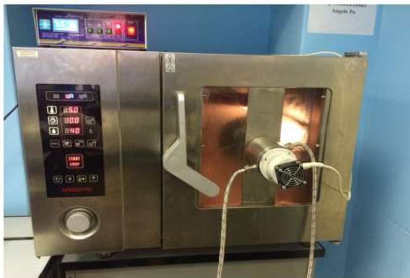
Общий вид экспериментальной установки, состоящей из пароконвектомата «Angelo Po Fx1e1» со встроенным ультразвуковым генератором «Соловей».
