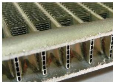
Рис. 6 Конструкция микроканального теплообменника
