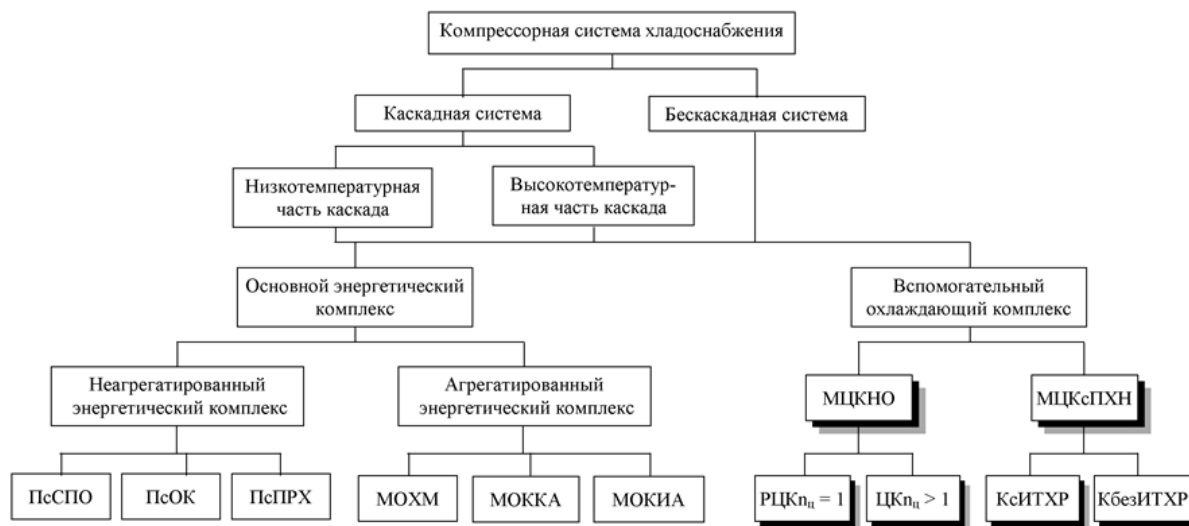
Иерархическая структура компрессорной холодильной установки
