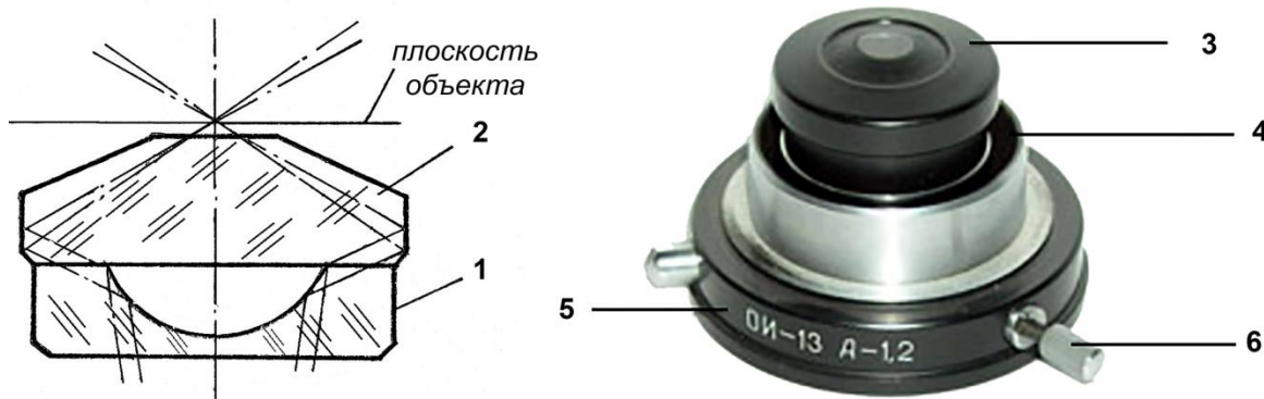
Рис. 3.2. Схема (слева) и внешний вид (справа) специального темнопольного конденсора ОИ-13 производства ЛОМО [10]
