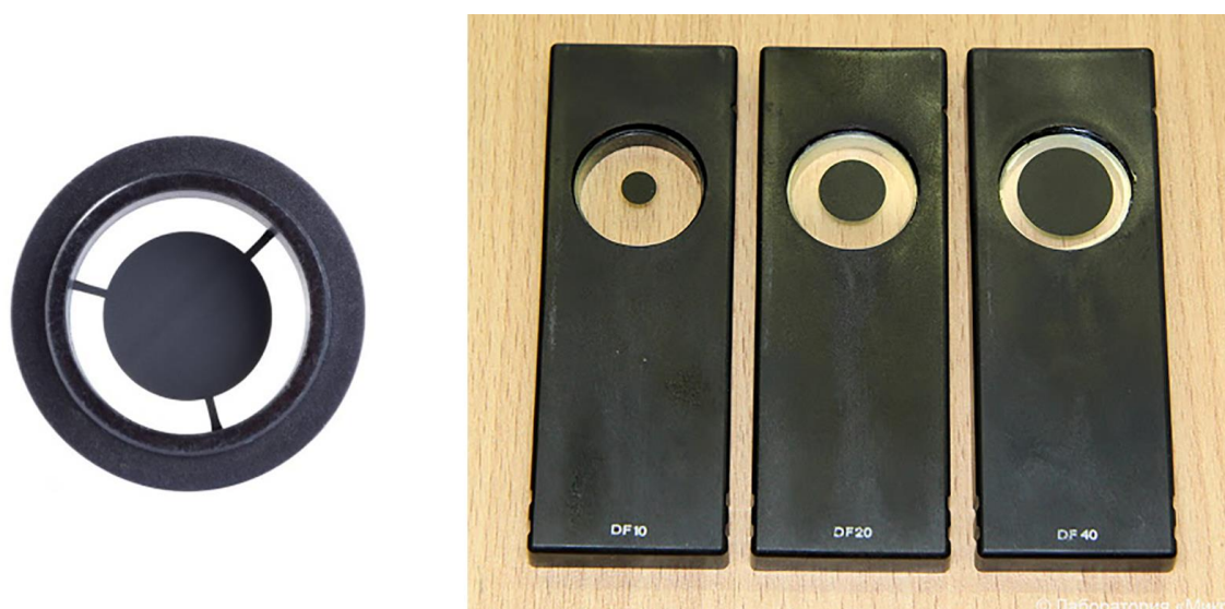
Рис. 3.5. Кольцевая диафрагма (слева) и специальные слайдеры с кольцевыми дисками, применяемые с объективами 10, 20 и 40 крат (микроскоп Jenamed, Zeiss).
