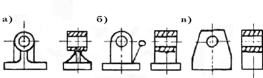
Рис.2.1 Возможные варианты конструкций кронштейнов.
