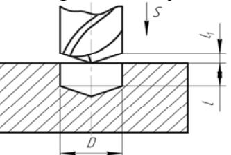
$L = l + l_1$                 | <p>8. Сверление сквозного отверстия</p>
