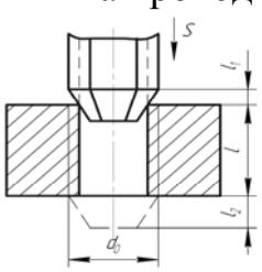
$L = L_{o\bar{b}p} = l + l_1 + l_2$ | <p><b>14. Нарезание резьбы плашкой</b></p>
