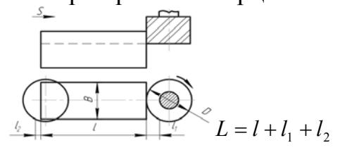
$L = l + l_1 + l_2$                                                                                                                                                            | <p><b>18. Фрезерование дисковыми фрезами на проход</b></p>
