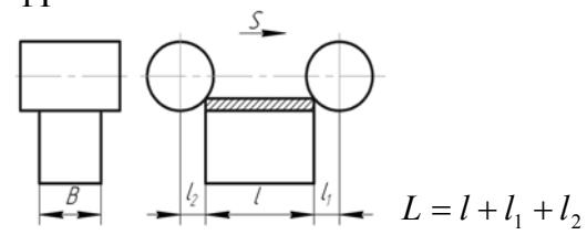
$L = l + l_1 + l_2$                                                                                                                                                      | <p><b>16. Фрезерование концевыми фрезами</b></p>
