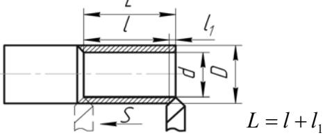
$L = l + l_1$ | <p>2. Обтачивание цилиндрической поверхности на проход</p>
