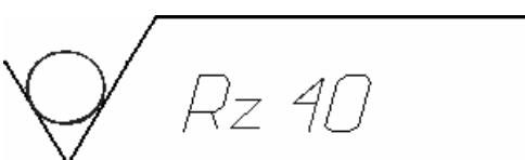
Значение шероховатости поверхности должно соответствовать допуску на заданный размер. Диаграмма (рис.1.1) позволяет ориентировочно определять минимально необходимую шероховатость поверхности по заданному допуску.
