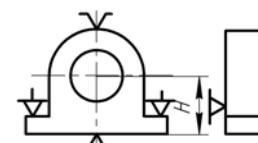
На магнитном столе при обработке плоскости с выдерживанием размера только по высоте
