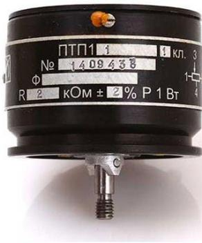
Рисунок 4.4 – Внешний вид потенциметрического датчика марки ПТП
