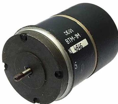
Рисунок 5.2 – Вращающийся трансформатор ВТМ-1М
