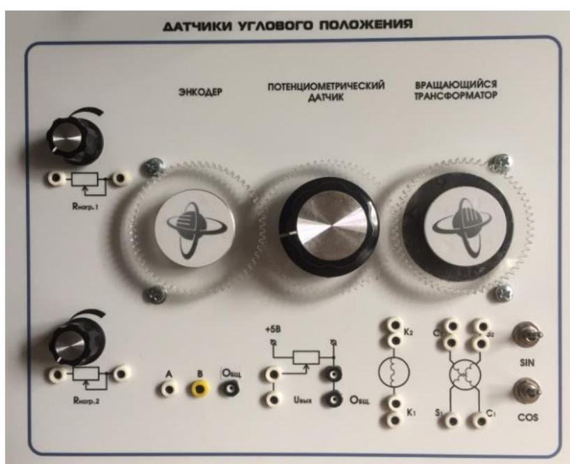
Рисунок 3.1 - Блок «Датчики углового положения»
