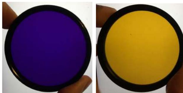
Рис. 54: Циркулярный поляризатор двумя сторонами к монитору. Поляризатор не идеальный, поэтому не происходит полного затемнения. Кроме того, он состоит из линейного поляризатора и четвертьволновой пластинки, ось повернута на  $45^\circ$ . Слева поляризатор ближе к экрану, справа- пластинка (в этом случае прошедшая интенсивность слабо зависит от поворота).
