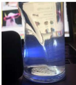
Рис. 56: Рассеяние Тиндаля на дезодоранте. Проходящий белый свет желтеет, так как синяя компонента рассеивается сильнее, а в боковом свете жидкость синяя.
