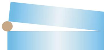
Рис. 12: Образование клина между двумя стеклами
