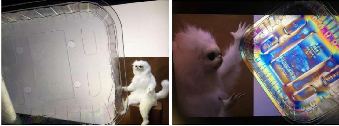
Рис. 58: Кусок пластмассы в свете монитора. Наблюдение в свете монитора без поляризатора и через поляризатор.
