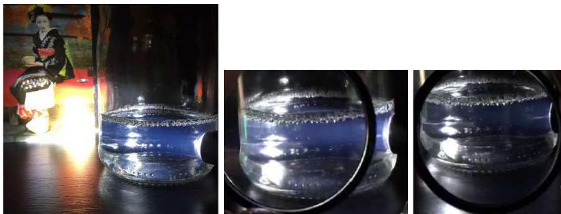
Рис. 57: Рассеяние Тиндаля от белого фонаря на мицеллярной воде. Луч внутри слегка синий и поляризован (то же самое происходит при рассеянии солнечного света в атмосфере, небо тоже поляризовано.[7])
