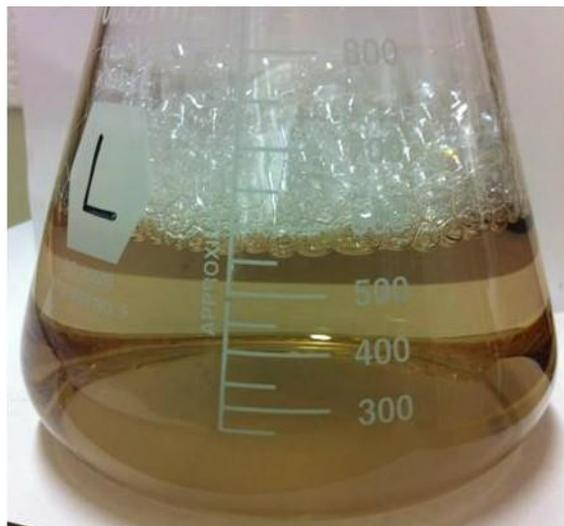
Рисунок 6.6 – Фотография смеси через 120 мин после введения раствора зародышей. Отсутствие красноватого оттенка в ростовом растворе свидетельствует об очень низкой концентрации примесей сферической формы.
