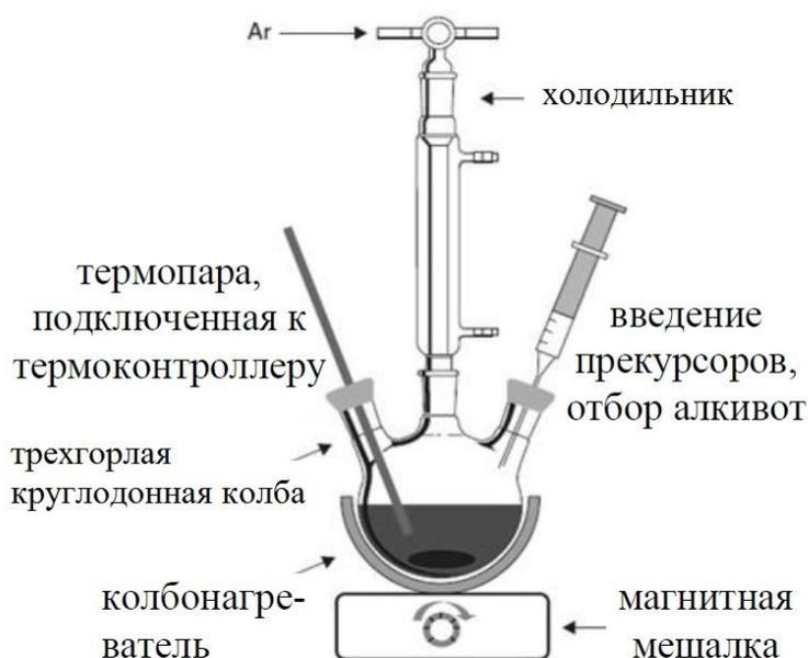
Рисунок 1.6 – Схема лабораторной установки для органического синтеза полупроводниковых наночастиц.
