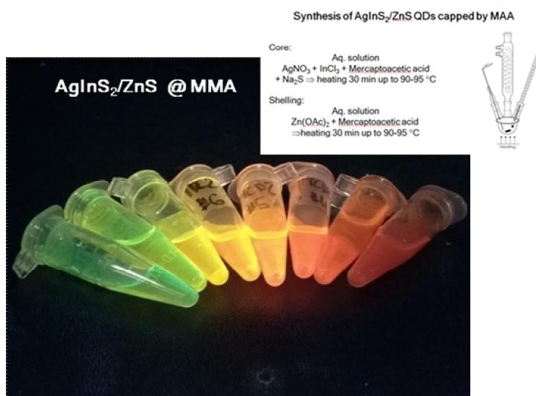
Рисунок 5.3 – Схема установки для синтеза (вверху) наночастиц AIS/ZnS и полученные фракции коллоидных растворов люминесцентных квантовых точек под УФ-лампой (внизу).
