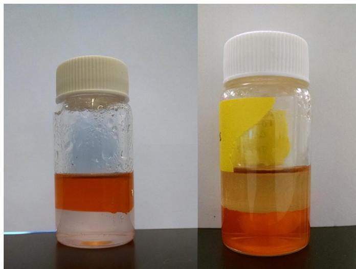
Рисунок 1.7 – Фото реакции замены лиганда: (слева) в начале реакции CdSe--ОлК в толуоле над раствором тиогликолята натрия в воде и (справа) почти завершенная реакция толуола над CdSe водном растворе тиогликолят натрия.
