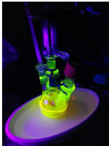
Рисунок 2.4 – Схема установки для синтеза коллоидных квантовых точек и изображение результата синтеза CdZnSe/ZnS
