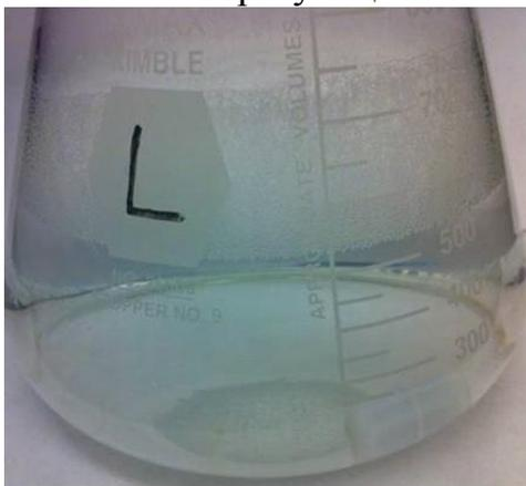
Рисунок 6.5 – Фотография бесцветной реакционной смеси через 90 минут после добавления H<sub>2</sub>AuCl<sub>4</sub>. Молекулы NaOL восстанавливают Au<sup>3+</sup> до Au<sup>+</sup> (AA ещё не добавляли в ростовой раствор).
