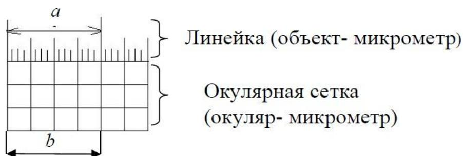
Рисунок 9 – Совмещение линейки объектмикрометра и делений окулярной сетки
