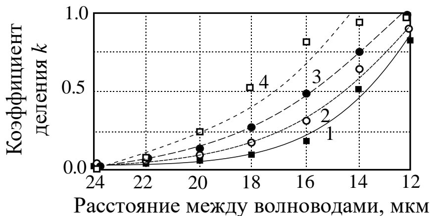
Рис. 5.9. Зависимость коэффициента деления направленного ответвителя от расстояния между волноводами при разном времени термической диффузии титана.
