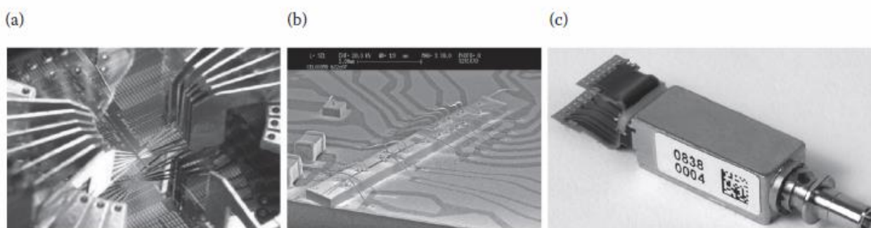
Рис. 2.18. (а) Интегрированный InP DSDBR перестраиваемый лазер с MZM на общей подложке. (б) Микросхема интегрированного InP DSDBR перестраиваемого лазера с MZM. (с) ILMZ TOSA блок для XFP приёмо-передатчиков [7].
