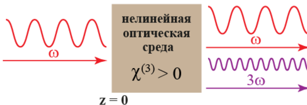
Рисунок 5.1 – Иллюстрация появления в нелинейной среде в поле монохроматического излучения волны на утроенной частоте
