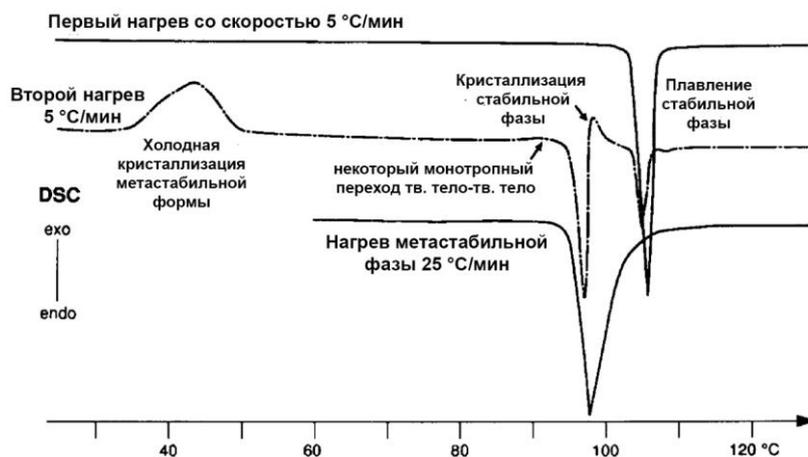
**Рисунок 1.15** - Кривые ДСК фенилбутазона. Первый запуск: форма плавится при 105 °С. Второй цикл: при 40 °С метастабильная модификация кристаллизуется из аморфной формы и плавится при 92 °С. Во время плавления появляется стабильная фаза (обозначенная экзотермическим пиком), которая плавится при 105 °С
