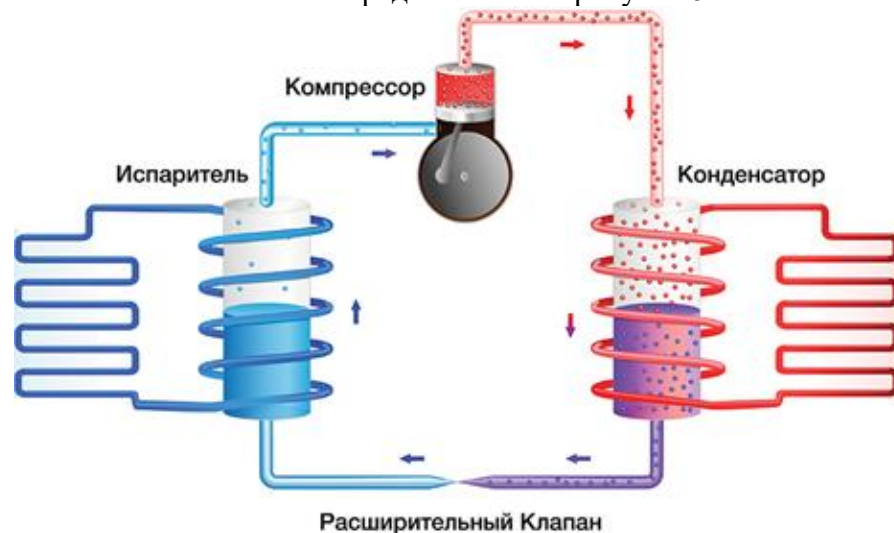
Рисунок 5 – Принципиальная схема парокомпрессионного теплового насоса
