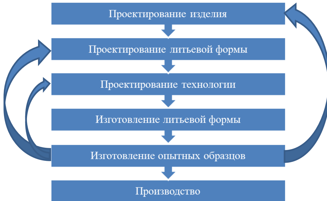
Рисунок 2 – Последовательность работ при традиционном подходе к подготовке производства из полимерных материалов
