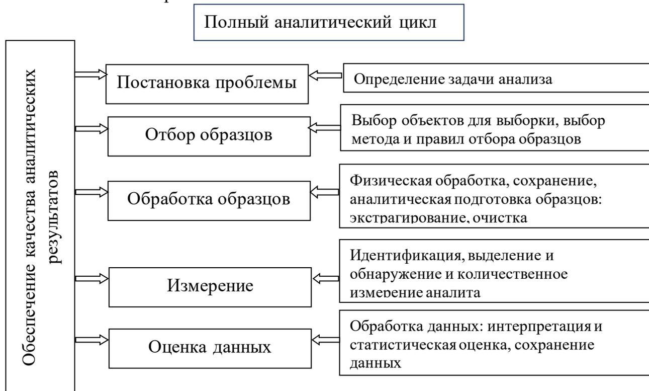
Рис. 1.2. Блок-схема полного аналитического процесса
