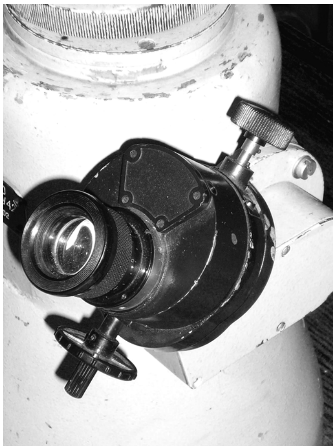
Рис. 10. Отсчетный измерительный микроскоп (в составе кольцевого сферометра)
