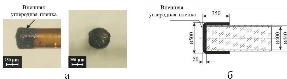
Рис. 1.22. Внешний вид (а) и схема (б) специально-инициализированного пленочного оптотермического волоконного углеродсодержащего конвертера.
