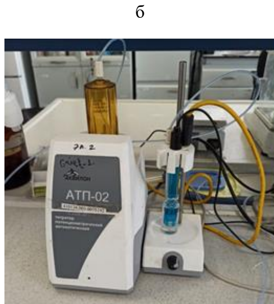
Рисунок 4 – Схема (а) и фотография (б) автоматического потенциометрического титратора АТП-02: 1 – блок титрования, 2 – бюретка, 3 – жидкостной тракт, 4 – комбинированный электрод для рН-метрии, 5 –термометр сопротивления, 6 – магнитная мешалка, 7 – якорь магнитной мешалки, 8 – штатив, 9 – носик жидкостного тракта, 10 – стакан с пробой, 11 – бутылка с титрантом
