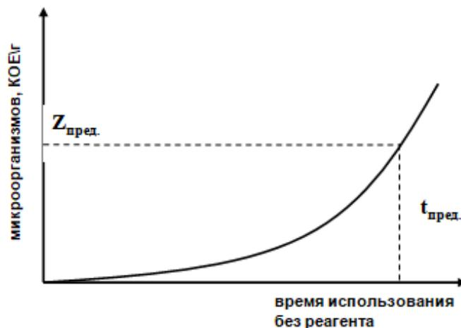
Рис.22. Графическое определение предельного использования раствора без реагентов ( $t_{пред.}$ )
