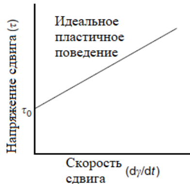
Рис. 3.9. Идеальное пластичное вещество при напряжениях ниже приложенного сдвига (предела текучести, \tau_0 ) ведет себя как твердое тело, а при более высоких напряжениях — как жидкость
