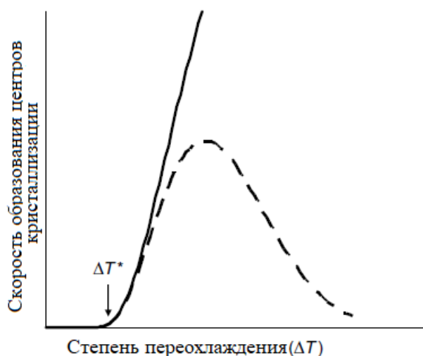
Рис. 3.14. Теоретически скорость образования стабильных зародышей кристаллов при переохлаждении должна возрастать (сплошная линия), но на практике она уменьшается до определенной температуры, поскольку диффузия молекул жира замедляется из-за увеличения вязкости (пунктирная линия)
