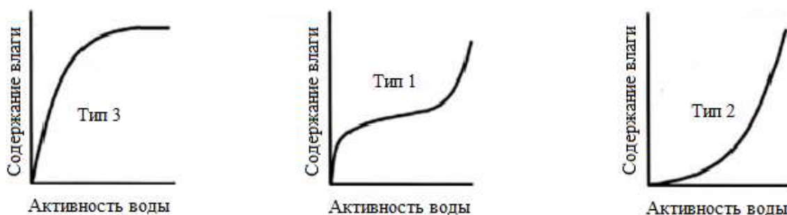
Рис. 1.5 Схематическое представление трех типов изотерм сорбции влаги, характерных для большинства пищевых продуктов: тип 1 – кристаллические вещества сахара и леденцовой карамели, тип 2 – белки, камеди и аморфные вещества, тип 3 – антислеживающие агенты, например, силикагель и некоторые соли, \text{CaCl}_2 \text{MgCl}_2
