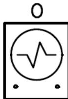
Рисунок 4.10. Обозначение осциллографа – прибора измерительного регистрирующего
