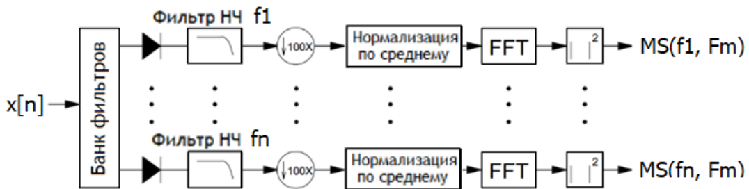
Рисунок 2.8 — Схема вычисления модуляционного спектра [13]
