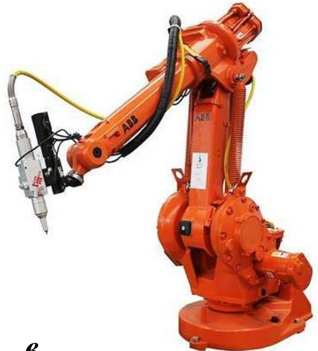
Рис. 8.2. Роботизированные манипуляторы различного исполнения: (а) монтаж сканирующей гальванометрической системы с коллиматором и волоконно-оптической системой доставки излучения [45], (б) монтаж лазерного источника на манипулятор с шарнирно-зеркальной системой доставки излучения, (в) монтаж коллиматора с волоконно-оптической системой доставки излучения и системой машинного зрения
