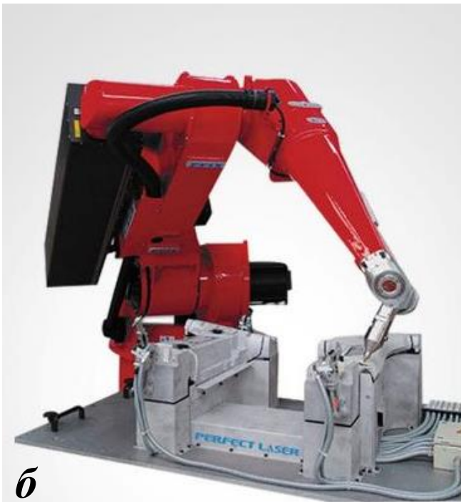
Рис. 8.2. Роботизированные манипуляторы различного исполнения: (а) монтаж сканирующей гальванометрической системы с коллиматором и волоконно-оптической системой доставки излучения [45], (б) монтаж лазерного источника на манипулятор с шарнирно-зеркальной системой доставки излучения, (в) монтаж коллиматора с волоконно-оптической системой доставки излучения и системой машинного зрения
