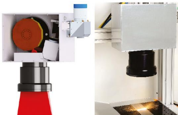
Гибридный полигонный сканатор с гальвозеркалом в пред-объективной системе (скорость сканирования 20 – 700 м/с) [35]
