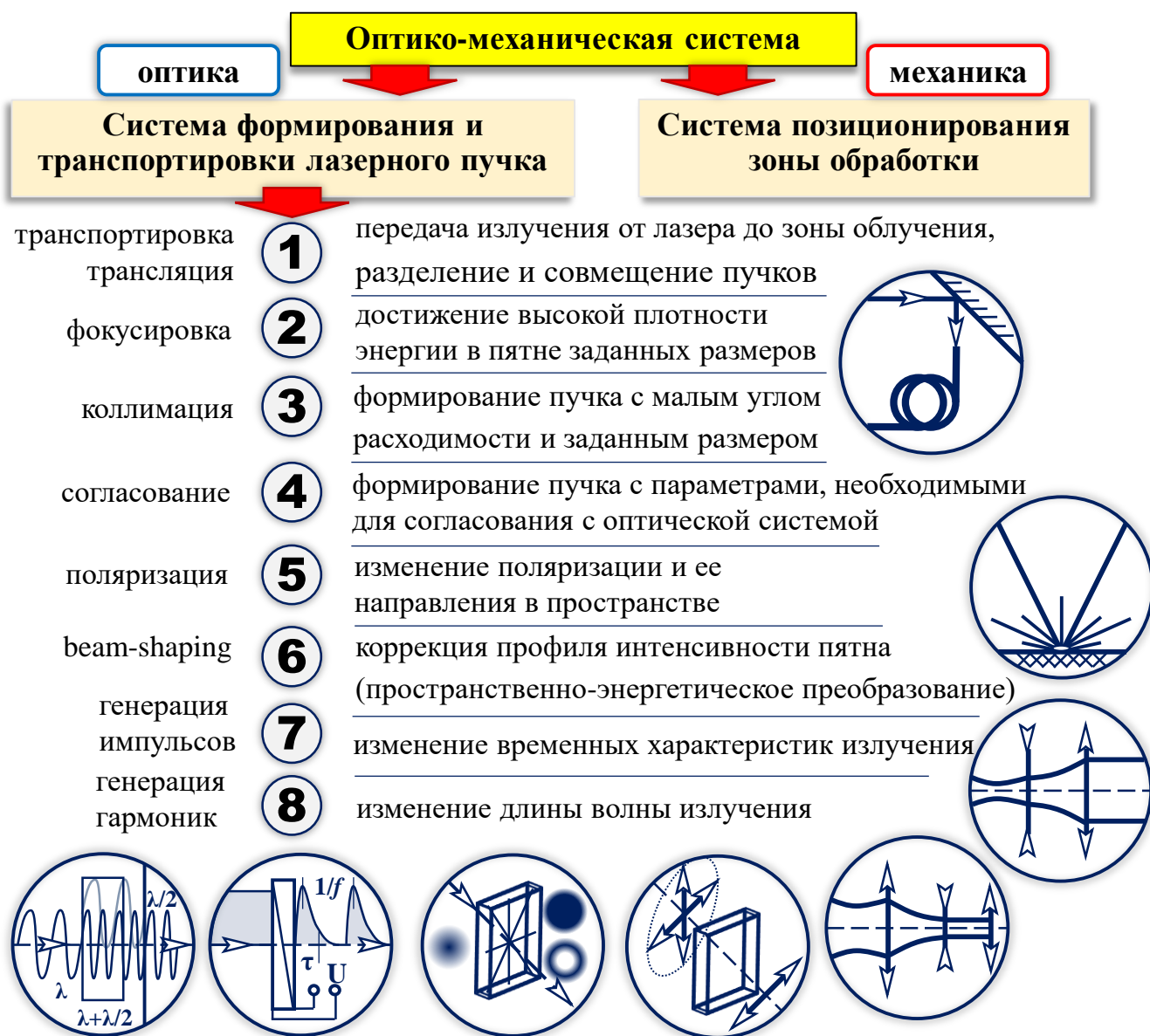
Рис. 2.1. Функции системы формирования и транспортировки лазерного пучка
