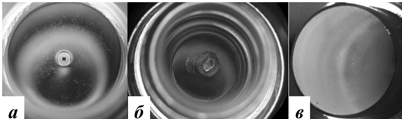
Рис. 8.3. Торцы волокна с сердцевиной квадратного сечения [45]: (а) в рабочем состоянии без разрушений, (б) внутреннее разрушение волокна; (в) внешнее разрушение AR-покрытия
