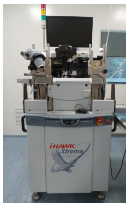
Рисунок 37 – Фото установки сварки проволочных контактов iHawk
