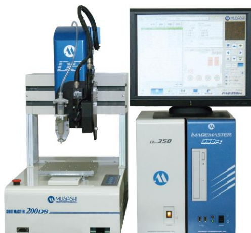
Рисунок 44 – Установка нанесения силиконовых материалов Musashi
