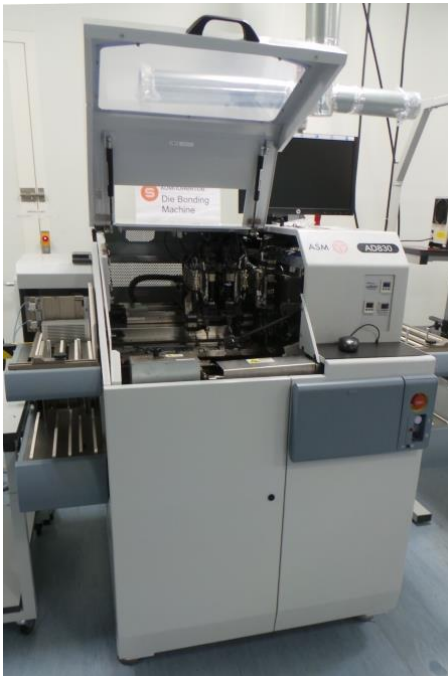
Рисунок 22 – Фотографии установки AD830 монтажа чипов в корпус
