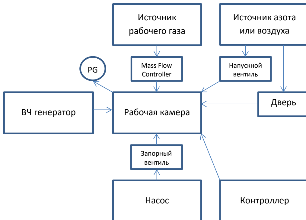
Рисунок 16 – Схема установки плазменной очистки
