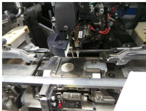
Рисунок 37 – Фото установки сварки проволочных контактов iHawk
