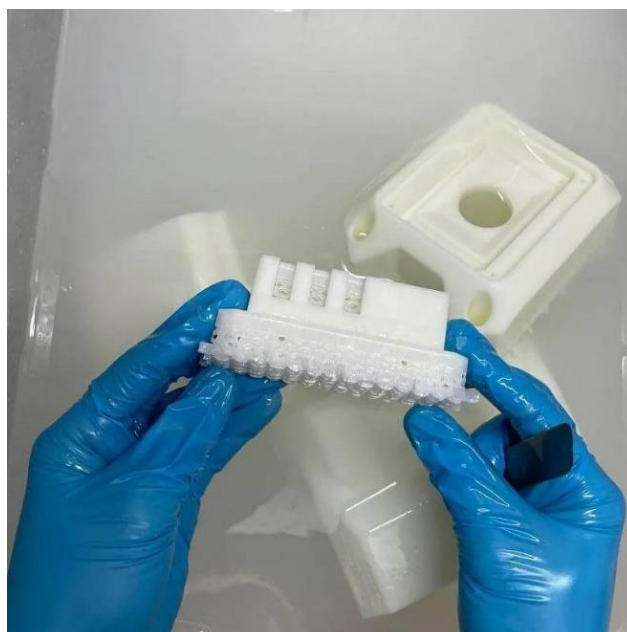
Рисунок 23 – Промывка деталей перед механической обработкой
