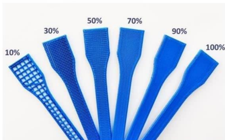
Рисунок 14 – Образцы с различной плотностью заполнения
