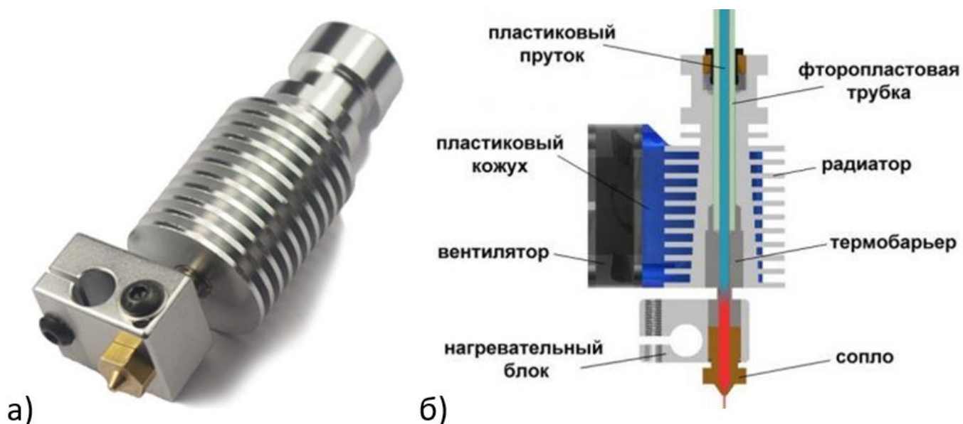
Рисунок 5 – Иллюстрация конструкции нагревателя: а) фотография; б) трехмерная модель (разрез)
