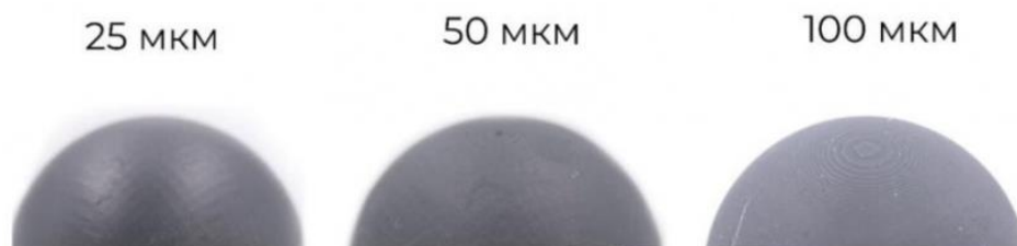
Рисунок 19 – Сравнение параметров толщины слоя
