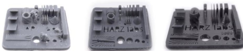
Рисунок 20 – Сравнение образцов, напечатанных с превышенным (слева), заниженным (посередине) и оптимальным (справа) временем засветки
