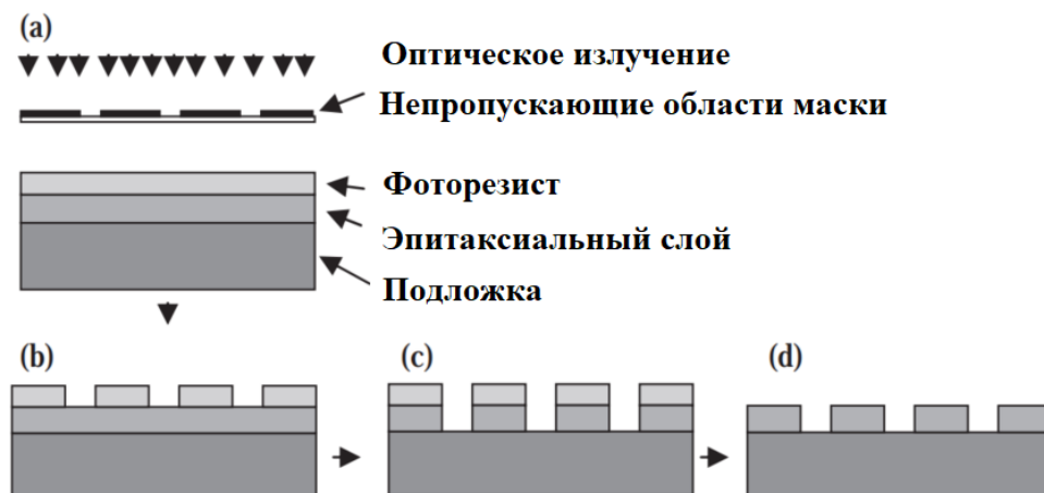
Рисунок 16 – Процесс фотолитографии: а) облучение фоторезиста б) формирование рисунка на фоторезисте, с) травление, d) удаление остатков фоторезиста [1]
