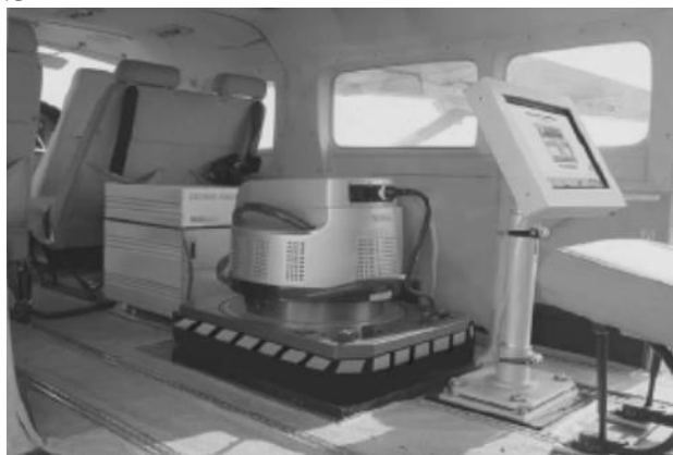
Рис. 4.4. Оптический блок панхроматического CCD линейного сканера ADS 80
