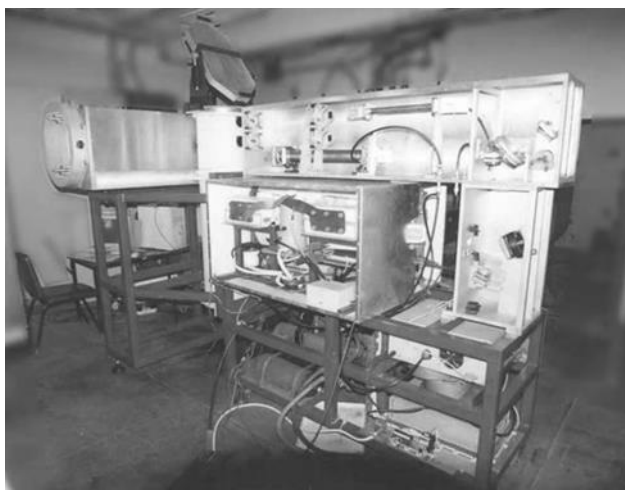
Рис. 4.12. Аппаратурная стойка многоволнового лидара-анализатора
