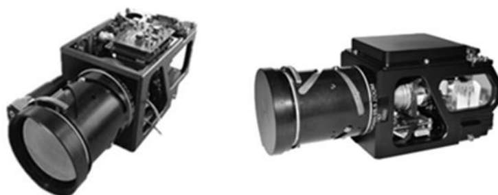
Рис. 6.5. ТПВС JN640-280 Miniature Airborne MWIR Cooled Thermal Camera
