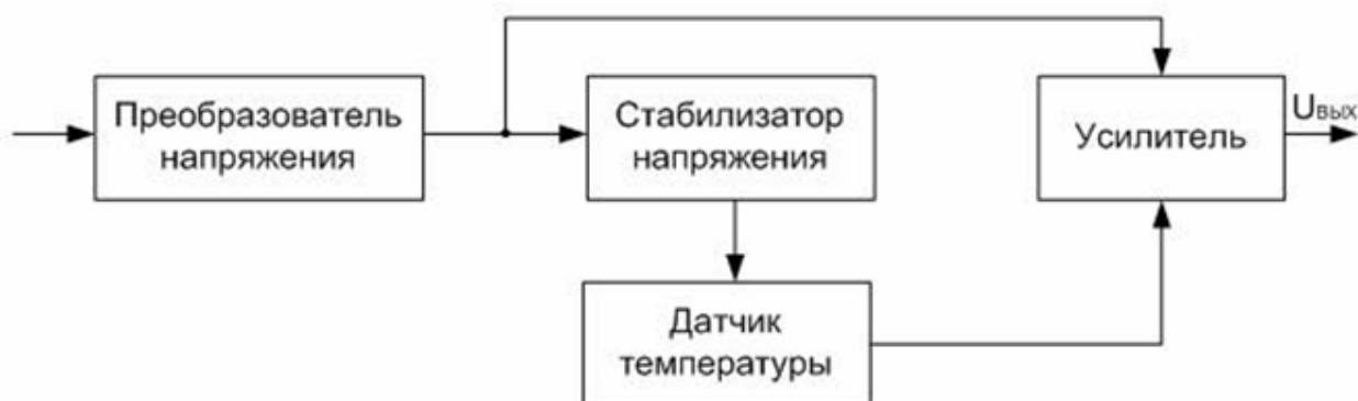
Рис. 5.9. Структурная схема измерения температуры полости прибора
