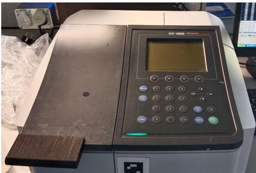
**Рисунок 3.1.** UV-VIS спектрофотометр, используемый в работе
