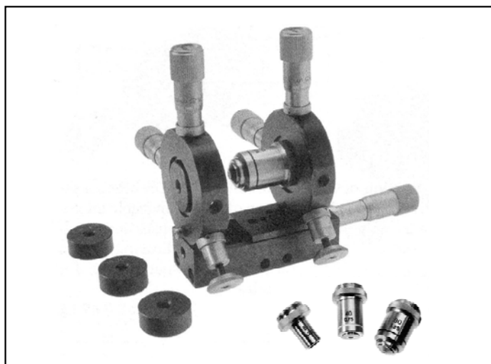
Рис.8. Пример оптико-механического узла, включающего микрообъектив и точечную диафрагму с трехкоординатной подвижкой, который осуществляет фильтрацию лазерного излучения от шумовых и рассеянных волн.
