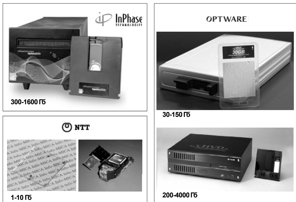
Рис.2. Голографические системы хранения информации, предлагаемые разными фирмами-изготовителями.
