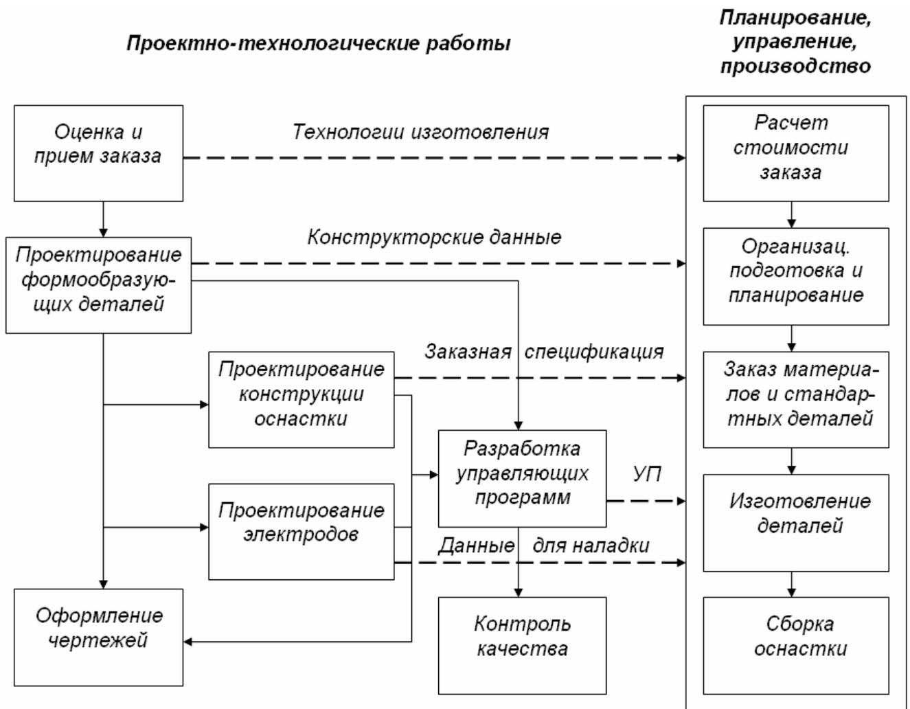
Рис. 5.3 Интегрированное выполнение работ при проектировании ФО и ФИ с использованием CAD/CAM Cimatron
