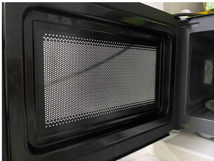
Рис. 5.12: Метаматериал на дверце СВЧ-печи: полупрозрачное покрытие не пропускает излучение СВЧ-диапазона, зато пропускает свет, позволяя видеть содержимое. Характерная длина волны электромагнитного излучения в СВЧ-печи составляет порядка 10 сантиметров и заметно превышает размеры ячеек сетки. Источник: https://www.ixbt.com/live/chome/pochemu-dverca-mikrovolnovki-meet-setchatyy-uzor.html .
