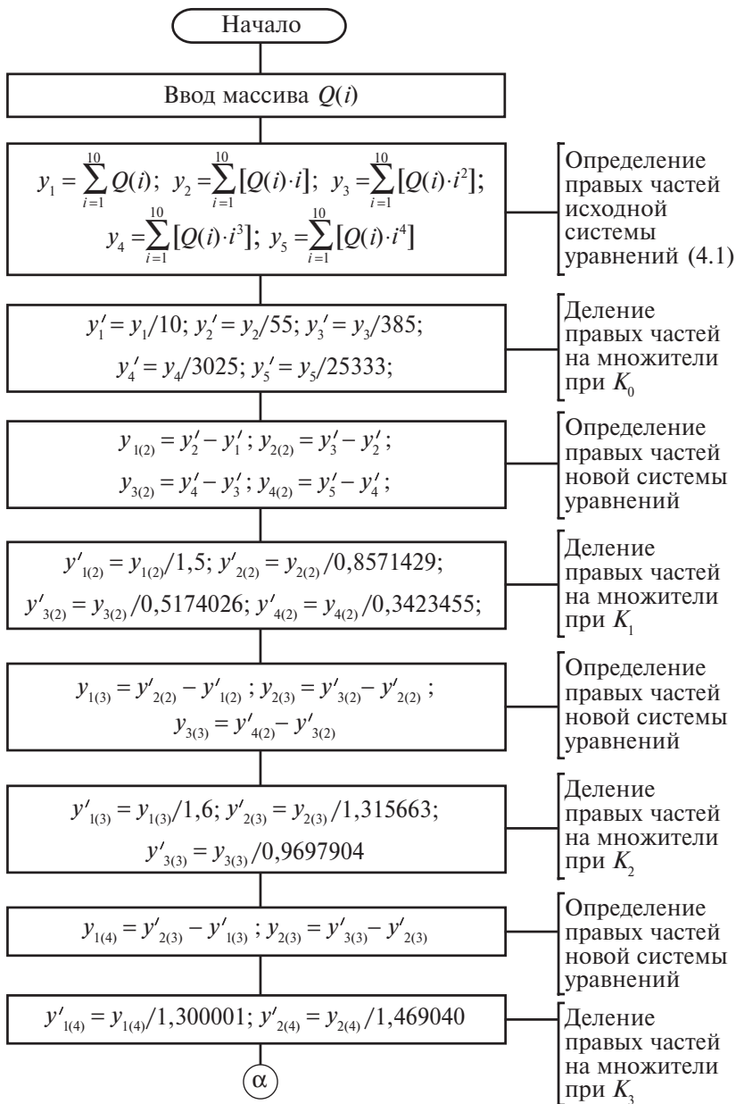
Рис. 4.5. Блок-схема алгоритма интерполяции.
