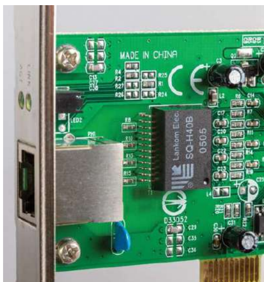
Рисунок 84 — Микросхема Ethernet PHY и трансформаторы гальванической развязки на плате
