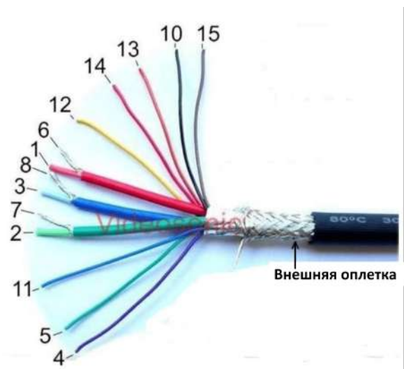
Рисунок 32 — Распиновка VGA-кабеля для передачи аналоговых видеосигналов
