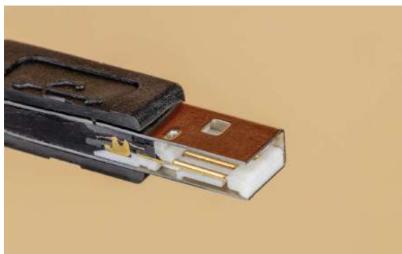
Рисунок 68 — Разъём USB Type-A (в разрезе)
