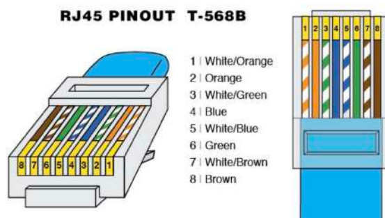
Рисунок 62 — Распиновка кабеля витой пары для Ethernet
