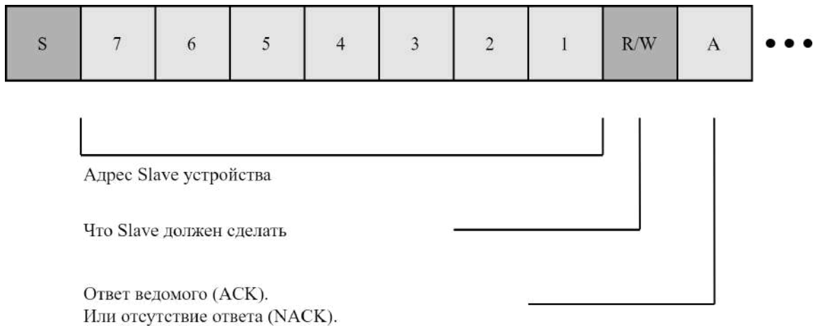
Рисунок 16 — Адресация в шине I 2 C
