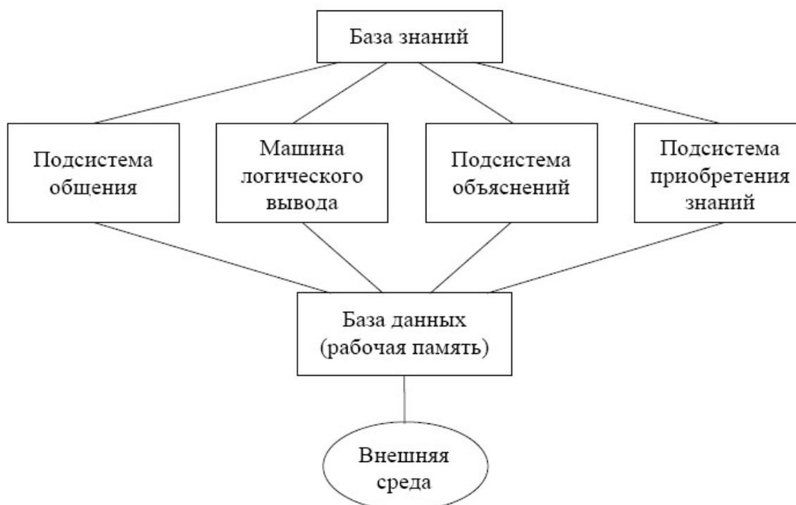
Рис. 4.1. Структура экспертной системы
