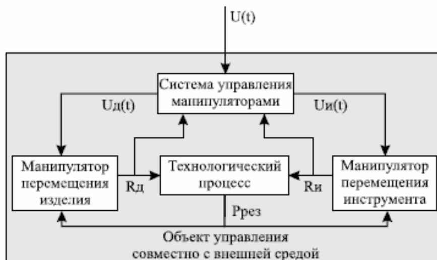
Рис. 6.5 Система управления интеллектуальным робототехническим комплексом
