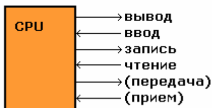
Рис. 2.3 Направление потоков данных
