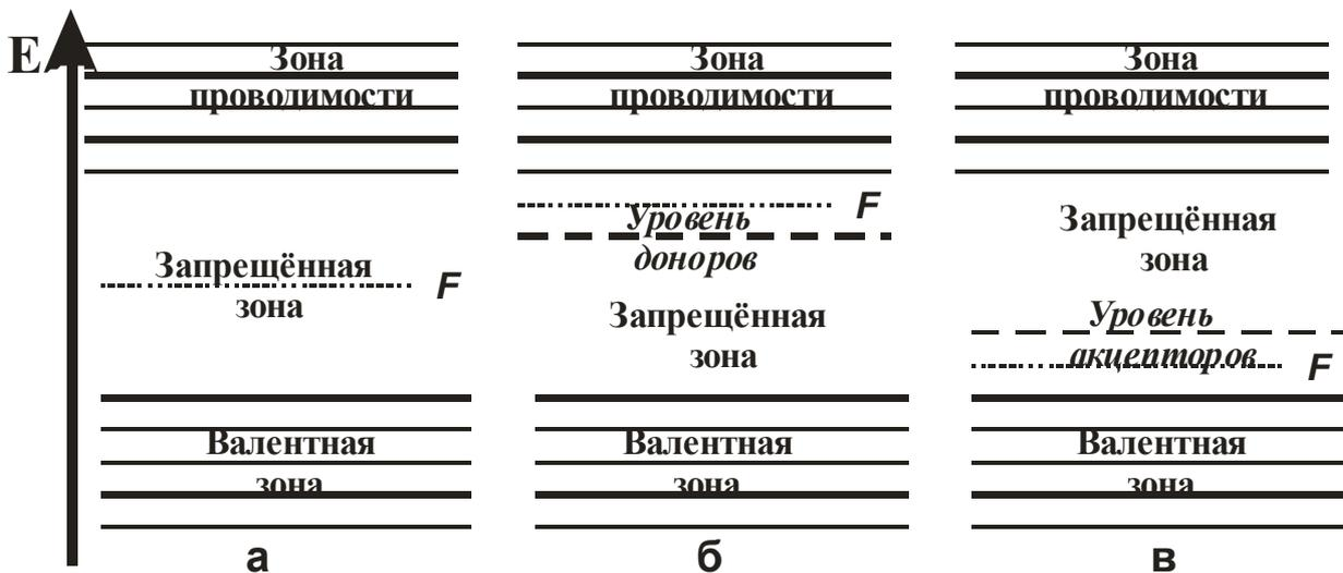
**Рис.1.** Зонная структура полупроводников. а – собственный полупроводник, б – полупроводник n-типа, в – полупроводник p-типа.  $F$  – уровень Ферми.
