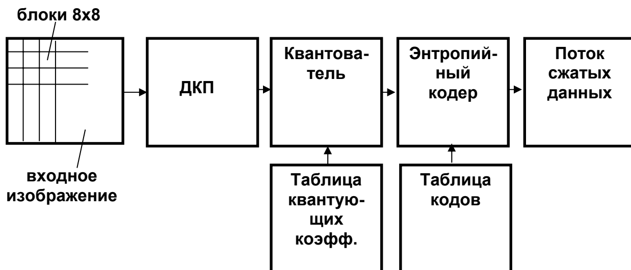
Рисунок 4.1 Схема кодера при кодировании по стандарту JPEG
