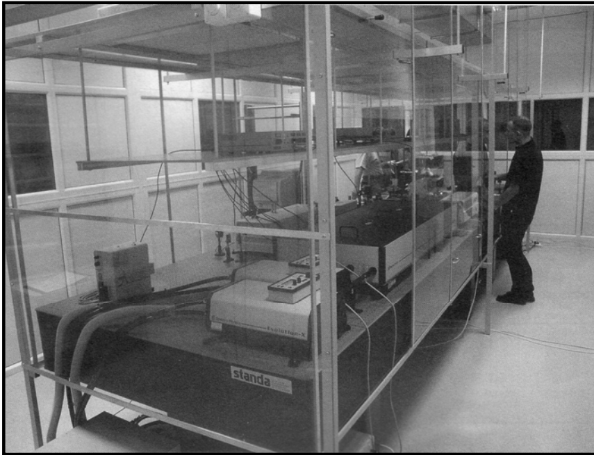
Рис.10.15. Пример голографической установки, механическую стабильность которой обеспечивает виброизолирующий стол фирмы «Станда».
