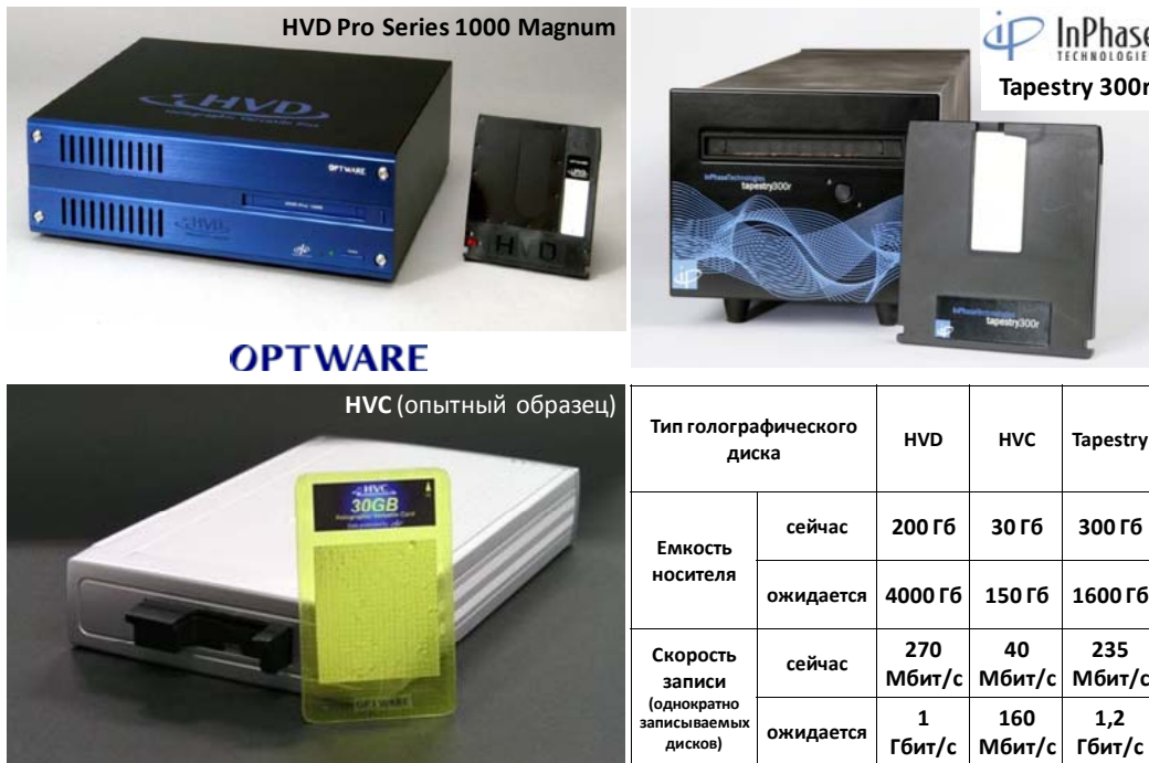
Рис.6.9. Голографические системы хранения информации, предлагаемые разными фирмами-изготовителями.
