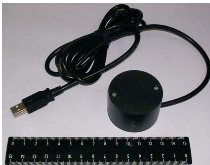
Безлинзовый цифровой голографический микроскоп Numerical Vision LDHM-4
