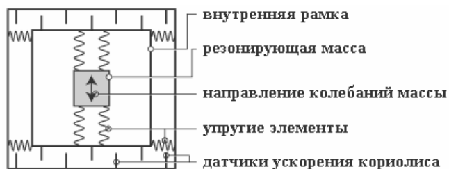
Рис. 5. Схема чувствительного элемента микромеханического гироскопа
