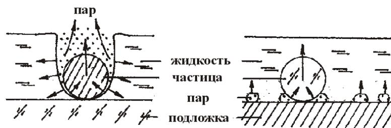
Рисунок: иллюстрация физического механизма влажной лазерной очистки.
