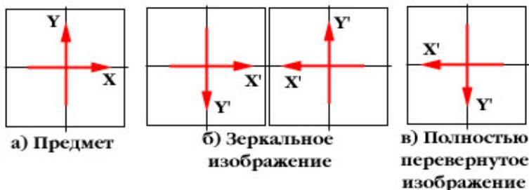
Если после системы зеркал наблюдатель видит, что одна из стрелок изменила направление на противоположное, то имеет место зеркальное изображение (рисунок б).
