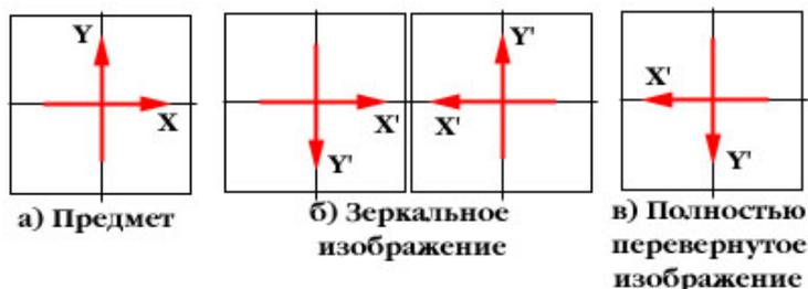
Если после системы зеркал наблюдатель видит, что одна из стрелок изменила направление на противоположное, то имеет место зеркальное изображение (рисунок б).
