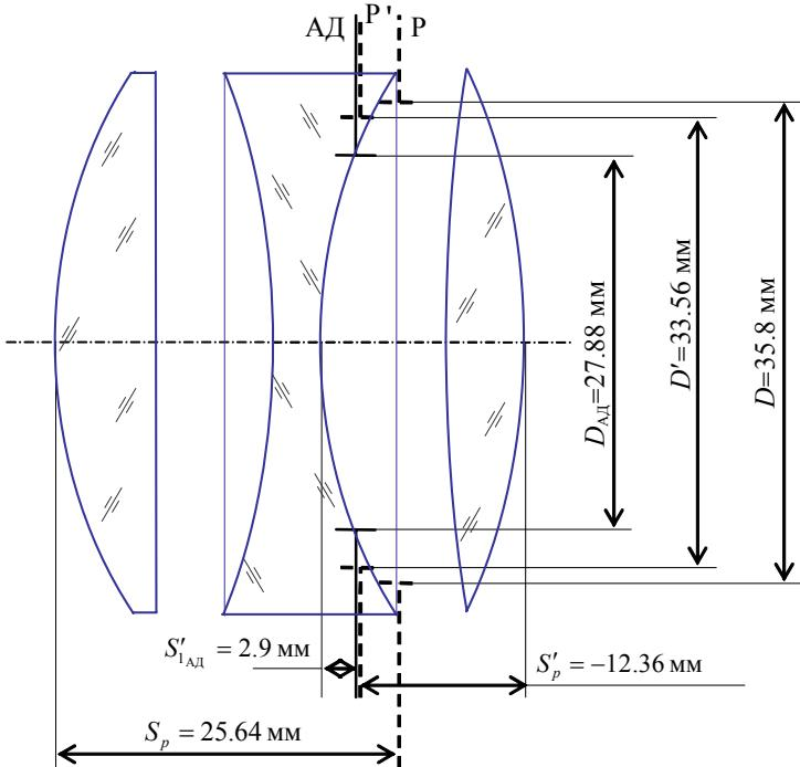
Рис.3.9. Чертеж объектива.
