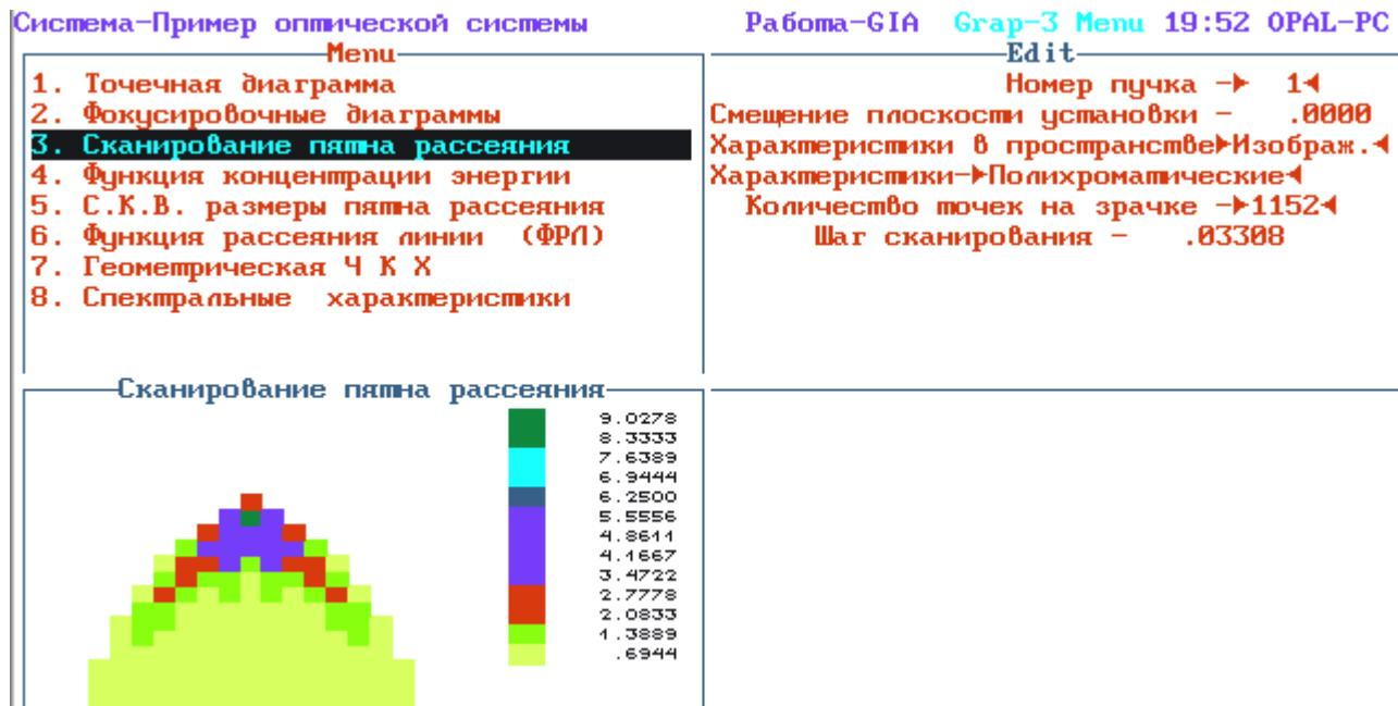
Рис.П2.40. Сканирование пятна рассеяния.
