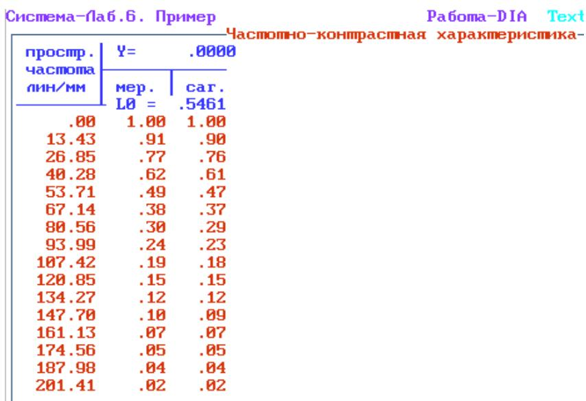
Рис.6.6. Частотно-контрастная характеристика в текстовом режиме.
