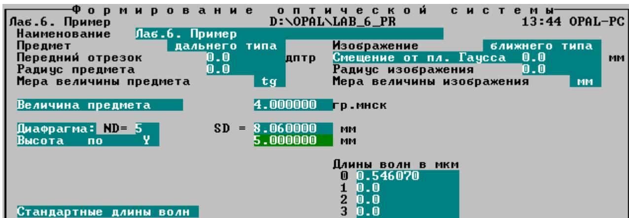
Рис.6.1. Параметры предмета, изображения, диафрагмы.
