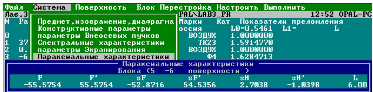
Рис.3.5. Параксиальные характеристики второй части объектива.
