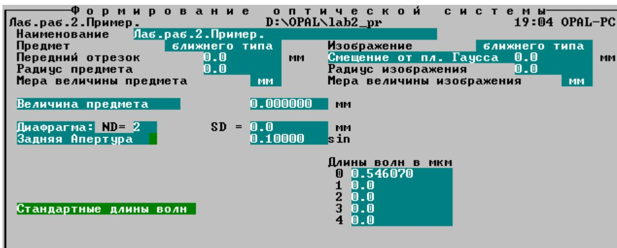
Рис.2.1. Параметры предмета, изображения, диафрагмы.
