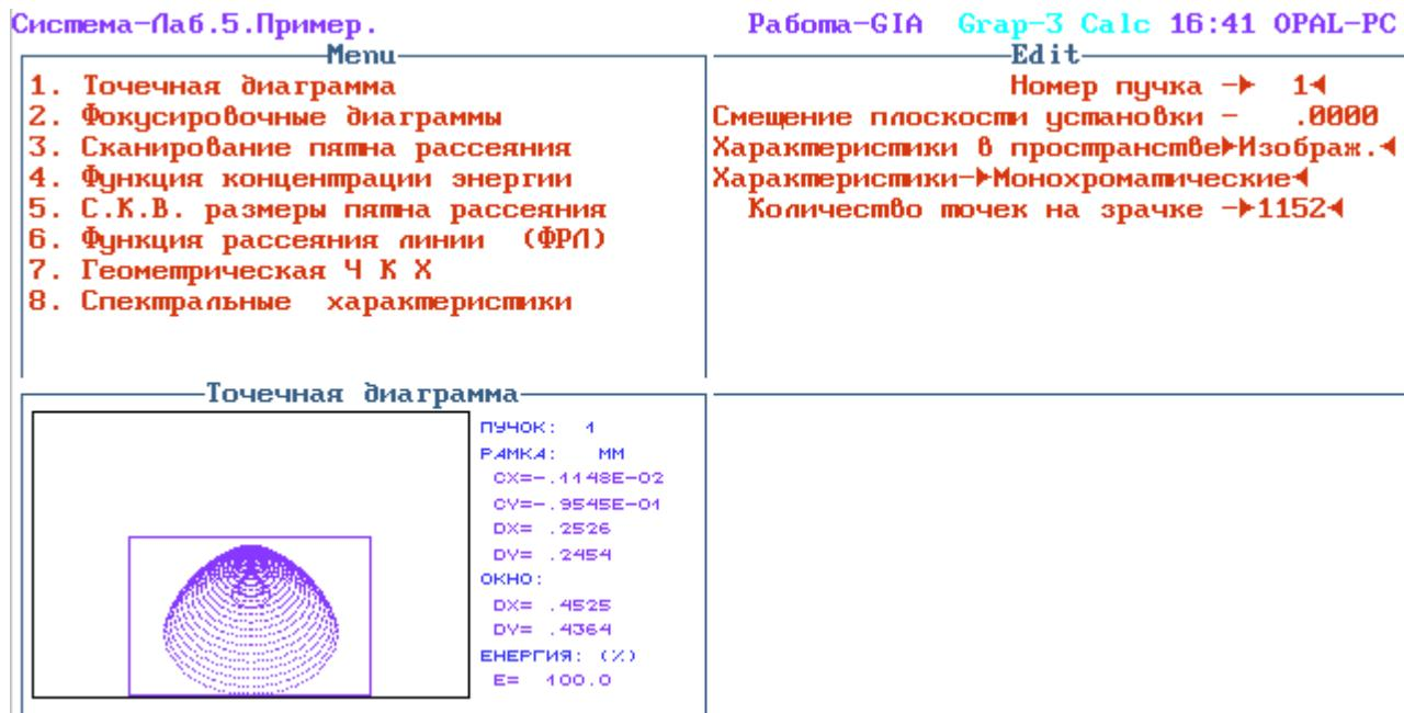
*Рис.5.9. Определение диаметра пятна рассеяния по точечной диаграмме.*
