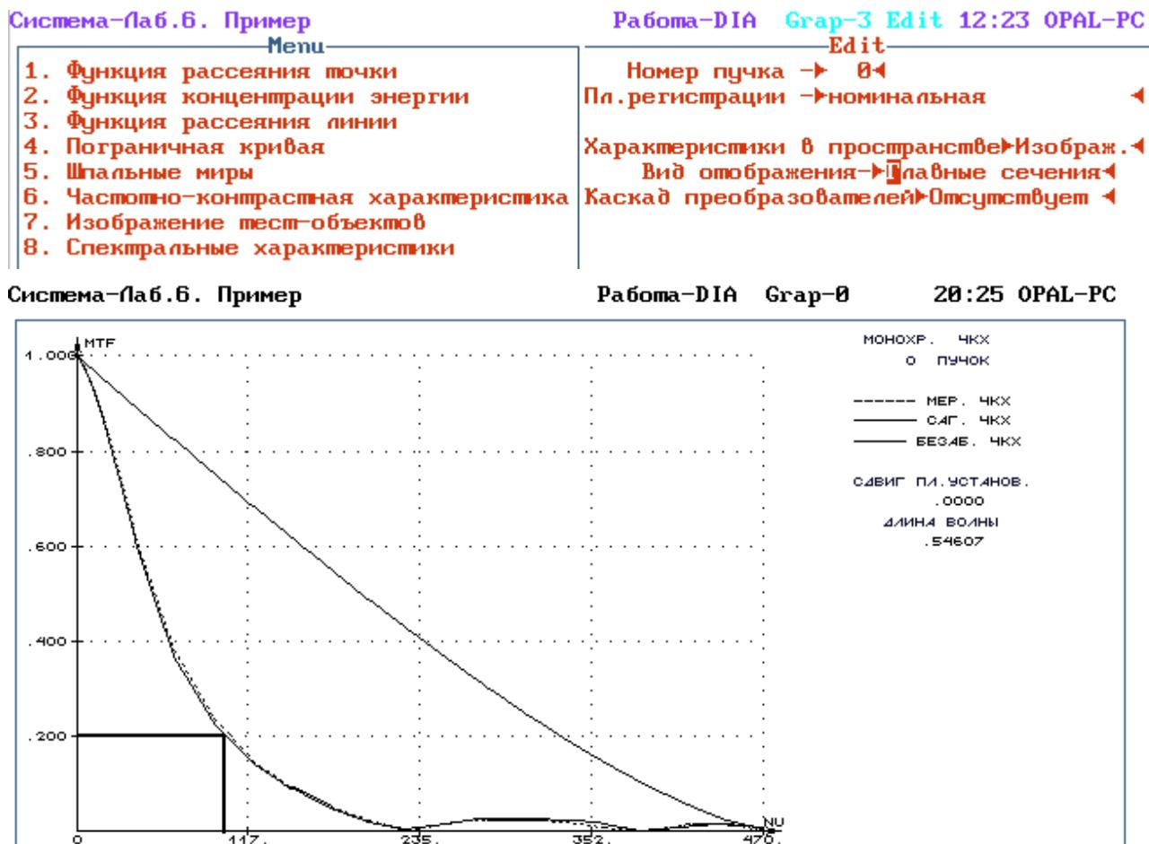
Рис.6.7. Частотно-контрастная характеристика в графическом режиме.
