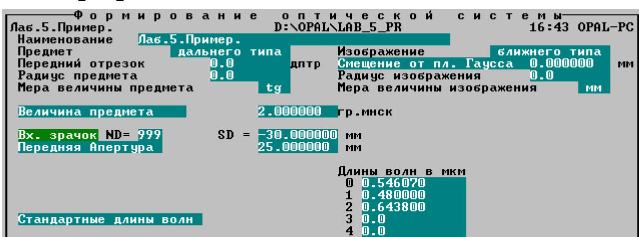
Рис.5.1. Параметры предмета, изображения, диафрагмы.
