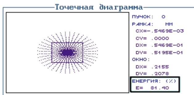
Рис.4.6. Определение диаметра пятна рассеяния.
