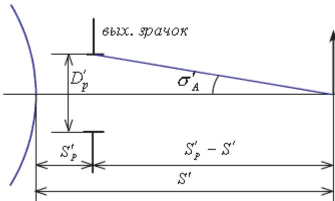
Рис.3.8. Задняя апертура.
