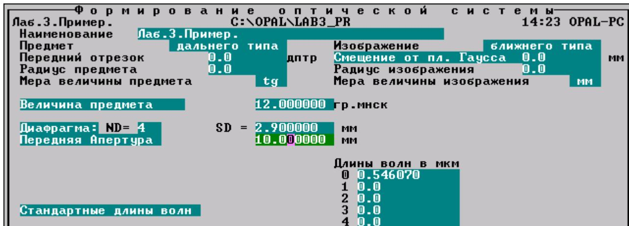
Рис.3.2. Параметры предмета, изображения, диафрагмы.
