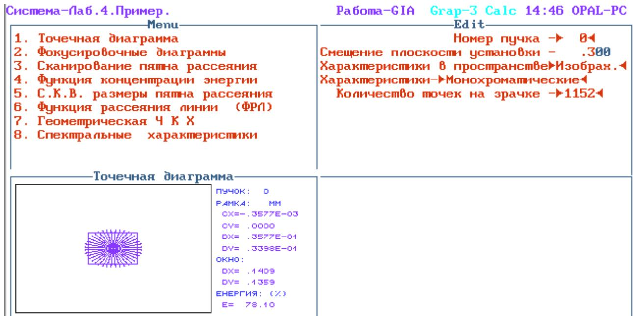
Рис.4.11. Диаметр пятна рассеяния в плоскости наилучшей установки.
