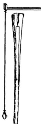
**Рис. 79. Бей – визирная дощечка с прорезью, устанавливаемая по отвесу.**
